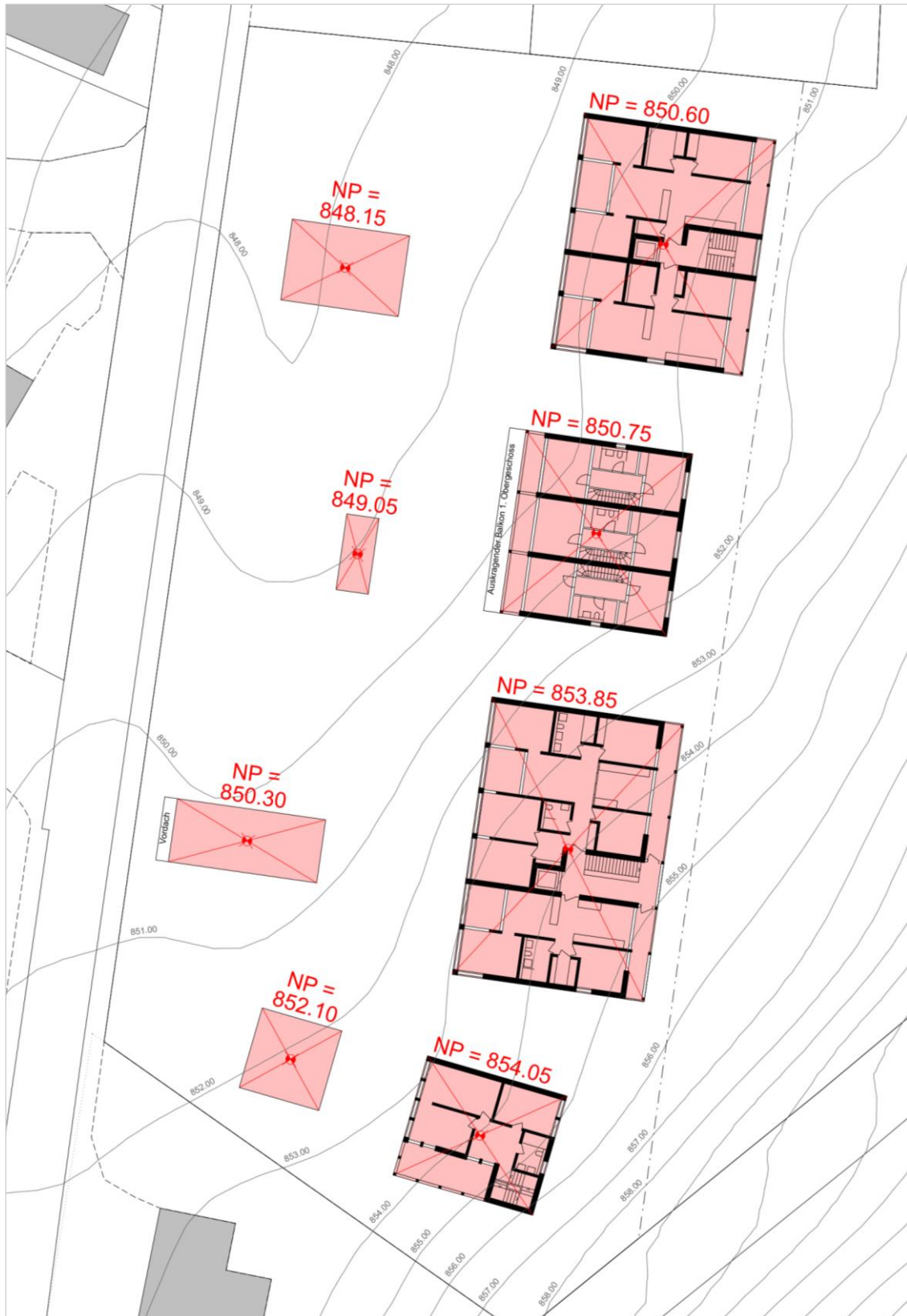
Abb. 18: Schema Bestimmung Niveaupunkte mit den jeweils relevanten Grundrissen (M. Keller)
